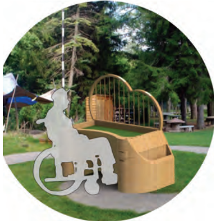
A fiókok fogantyúi 10 cm szélesek, és alulról felfele "belekapaszkodva" lehet kihúzni őket.
